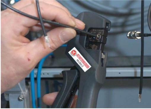
Professionelles Crimpwerkzeug mit Wechselbacken für Installateure und Servicetechniker.
