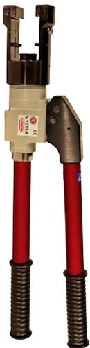
Geprüfte und zertifizierte hydraulische Handcrimpzange zum Crimpen von Cu-Verbindern vom Typ KRF/KSF 10-400 mm<sup>2</sup>, Al-Verbindern 16-400 mm<sup>2</sup> (-240 massiv) und C-Hülsen bis zu einem Gesamtquerschnitt von 240 mm<sup>2</sup> (C95-120).
