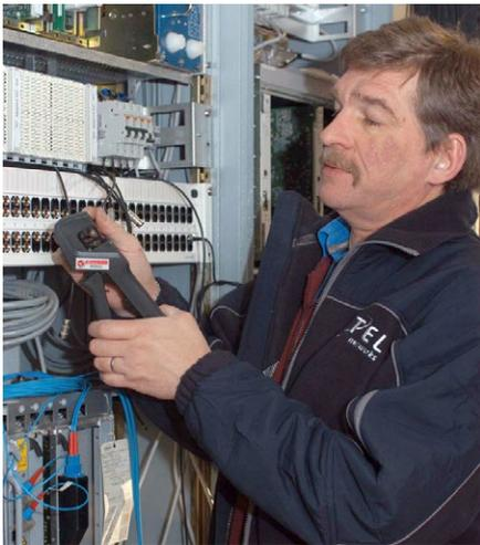
Elpress Mobile: Professionelles Werkzeug mit Wechselbacken für Installateure und Servicetechniker.
