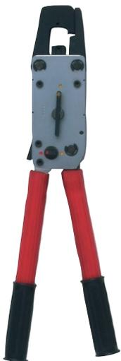
Mechanische Handcrimpzange zum Crimpen von Cu-Verbindern vom Typ KR/KS 10 mm<sup>2</sup>, KRF/KSF 16-95 mm<sup>2</sup>, KR/D/KSD 16-120 mm<sup>2</sup>, KRT/KST 10-120 mm<sup>2</sup>, Al-Verbindern 16-25 mm<sup>2</sup> (-35 massiv), C-Hülsen 6/6-50/50 mm<sup>2</sup> und DIN 46235 10-95 mm<sup>2</sup>.
