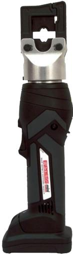
Akkuwerkzeug zum Crimpen von Rohrkabelschuhen und Stoßverbindern vom Typ KR/KS, KRF/KSF 10-70 mm<sup>2</sup>, KRT 10-70 mm<sup>2</sup>, KR/D/KSD 10-95 mm<sup>2</sup> mit speziellen „MB“-Pressbacken.
