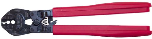
Geprüfte und zertifizierte mechanische Handzange zum Crimpen von Cu-Verbindern vom Typ CUT 6-16 mm<sup>2</sup> und KR/KRF/KS/KSF 4-16 mm<sup>2</sup>.
