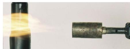
Die Schrumpfung der Isolierung erfolgt mittels Wärmezufuhr.
