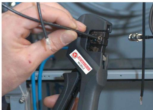
Professionelles Crimpwerkzeug mit Wechselbacken für Installateure und Servicetechniker.
