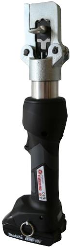
Geprüftes und zertifiziertes Akku-Crimpwerkzeug zum Crimpen von Cu-Verbindern vom Typ KR/KS 10 mm<sup>2</sup>, KRF/KSF 16-150, KR/D/KSD 16-185 mm<sup>2</sup>, KRT/KST 10-240 mm<sup>2</sup>, Al-Verbindern 16-25 mm<sup>2</sup> (-35 massiv), C-Hülsen 6/6-50/50 mm<sup>2</sup>, DIN 46235 10-95 mm<sup>2</sup>. PVX611DB wird mit einem zusätzlichen Akku geliefert.
