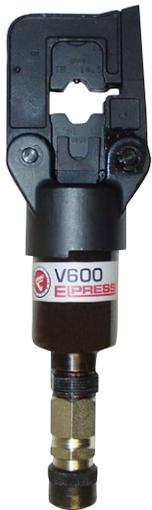
Geprüfter und zertifizierter Crimpkopf zum Crimpen von Cu-Verbindern vom Typ KR/KS 10 mm<sup>2</sup>, KRF/KSF 16-150 mm<sup>2</sup>, KR D/KSD 16-185 mm<sup>2</sup>, KRT/KST 10-240 mm<sup>2</sup>, Al-Verbindern 16-25 mm<sup>2</sup> (-35 massiv), C-Hülsen 6/6-50/50 mm<sup>2</sup> und DIN 46235 10-95 mm<sup>2</sup>.
