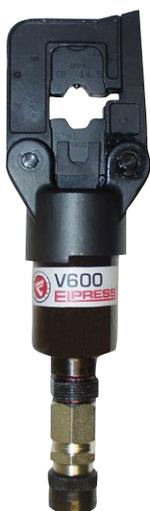
Geprüfter und zertifizierter Crimpkopf zum Crimpen von Cu-Verbindern vom Typ KR/KS 10 mm<sup>2</sup>, KRF/KSF 16-150 mm<sup>2</sup>, KR D/KSD 16-185 mm<sup>2</sup>, KRT/KST 10-240 mm<sup>2</sup>, Al-Verbindern 16-25 mm<sup>2</sup> (-35 massiv), C-Hülsen 6/6-50/50 mm<sup>2</sup> und DIN 46235 10-95 mm<sup>2</sup>.
