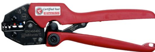
Geprüfte und zertifizierte mechanische Miniforce-Handzange zum Crimpen isolierter Verbinder 0,5-2,5 mm<sup>2</sup> sowie isolierter und unisolierter Aderendhülsen 0,25-4 mm<sup>2</sup>.
