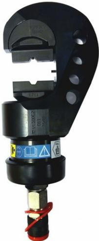
Crimpkopf mit patentierter DUAL-Crimptechnik zum Crimpen von Cu-Verbindern vom Typ KR/KRF und KS/KSF 10-300 mm<sup>2</sup>. Wird in Verbindung mit der Fußpumpe P4000 oder der elektrischen Pumpe PS710 verwendet. (PS710E auch als akkubetriebene Ausführung erhältlich).
