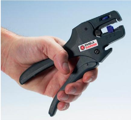
EMBLA, ergonomisch optimiertes Abisolier- und Schneidwerkzeug.
