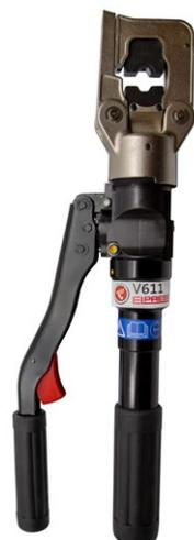
Geprüfte und zertifizierte hydraulische Handcrimpzange zum Crimpen von Cu-Verbindern vom Typ KR/KS 10 mm<sup>2</sup>, KRF/KSF 16-150 mm<sup>2</sup>, KR D/KSD 16-185 mm<sup>2</sup>, KRT/KST 10-240 mm<sup>2</sup>, Al-Verbindern 16-25 mm<sup>2</sup> (-35 massiv), C-Hülsen 6/6-50/50 mm<sup>2</sup>, DIN 46235 10-95 mm<sup>2</sup>.
