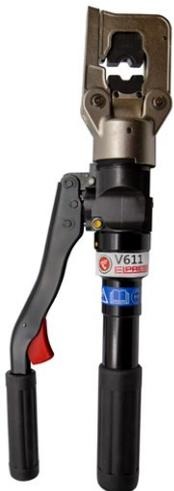
Geprüfte und zertifizierte hydraulische Handcrimpzange zum Crimpen von Cu-Verbindern vom Typ KR/KS 10 mm<sup>2</sup>, KRF/KSF 16-150 mm<sup>2</sup>, KR D/KSD 16-185 mm<sup>2</sup>, KRT/KST 10-240 mm<sup>2</sup>, Al-Verbindern 16-25 mm<sup>2</sup> (-35 massiv), C-Hülsen 6/6-50/50 mm<sup>2</sup>, DIN 46235 10-95 mm<sup>2</sup>.
