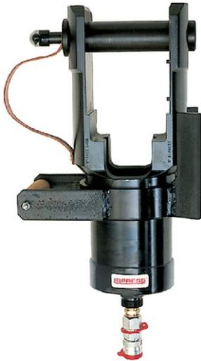
Geprüfter und zertifizierter Crimpkopf zum Crimpen von Cu-Verbindern vom Typ KRF/KSF 500-800 mm<sup>2</sup>, KRK/KSD, KRT/KST 500-1000 mm<sup>2</sup>, Al-Verbindern 800-1200 mm<sup>2</sup> und C-Hülsen 245-540 mm<sup>2</sup> (C150-185 und C240-300). Wird in Verbindung mit der Fußpumpe P4000 oder der elektrischen Pumpe PS710 verwendet.
