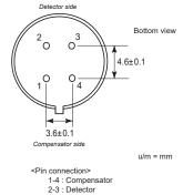
Fig. 3 - Sensor dimensions
