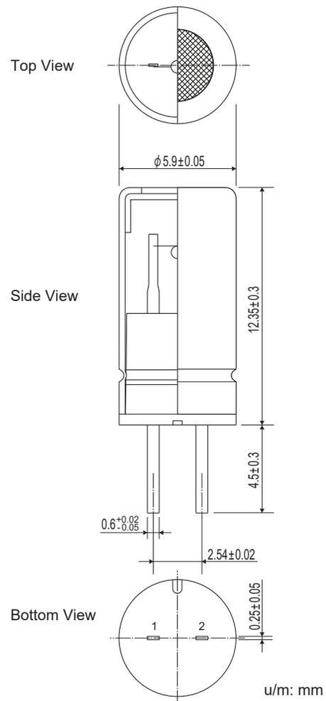
Fig. 3 - Sensor dimensions
